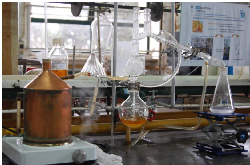
Figura 3 - Destilação por arrastamento de vapor
