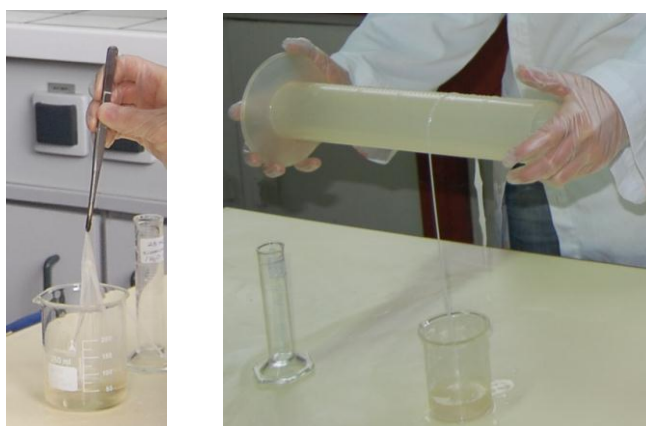
Figura 12 – Formação do fio de nylon
