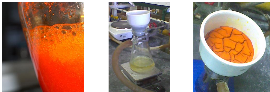
Figura 10 – Precipitação do produto e filtração em vácuo
