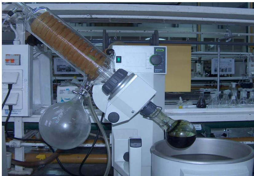
Figura 7 – Destilação do etanol num rotavapor.
