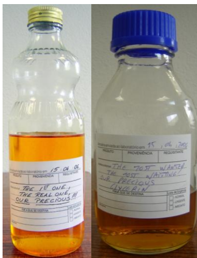
Figura 5- Primeiro biodiesel e respectiva glicerina após arranque na Unidade de Produção de Biodiesel (UPB) da Iberol.
