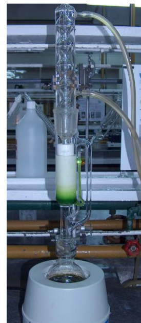
Figura 5 – Extração da clorofila em soxhlet
