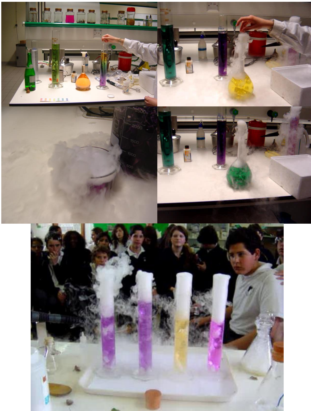
Figura 19- Preparando uma proveta com indicador universal para as experiências de ácido -base envolvendo gelo seco. Preparando um balão com indicador universal para libertar fumos com gelo seco. Libertação de fumos numa solução com couve roxa, indicador de pH, em provetas e balões.
