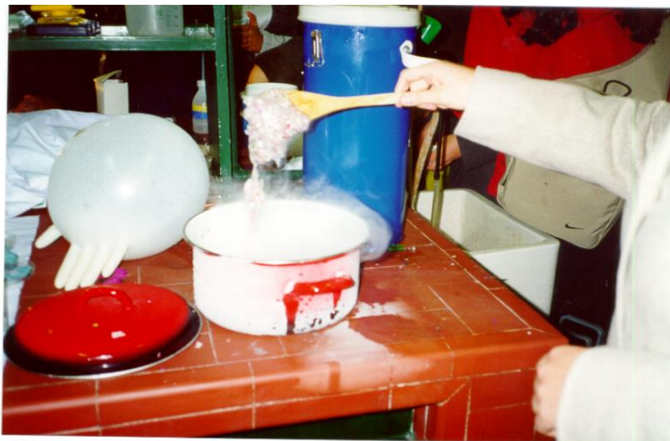
Figura 11- Preparação do slush (lama) de etanol, num tacho-são visíveis os cristais de gelo formados à volta do tacho de esmalte, recipiente que não é isolado. Do lado esquerdo, sublimação de gelo seco introduzido numa luva de latex.
