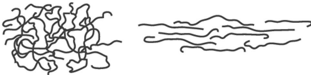
As longas cadeias moleculares na borracha não esticada e esticada (sob tensão)
