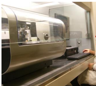
Imagem de uma impressora de jacto de tinta usada para imprimir "motivos" de polímeros
