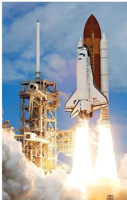
Fig. 2 Lançamento de um Space Shuttle. São visíveis os dois foguetes de combustível sólido e o enorme reservatório de combustível e comburente líquidos (de http://en.wikipedia.org/wiki/File:STS120LaunchHiRes-edit1.jpg ).
