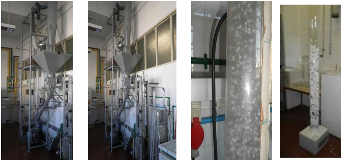
Instalação de transporte pneumático -- Fluidização de partículas de polímero e pedaços de esferovite.
