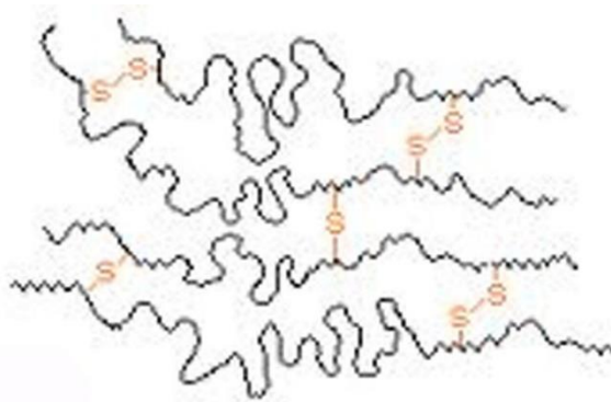
Estrutura da borracha vulcanizada com enxofre.
