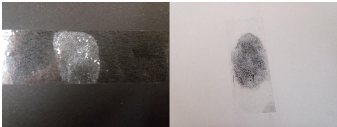
Fig. 2 – Revelação de uma impressão digital através do método de adsorção com um pó branco (esquerda) ou com um pó preto (direita).
