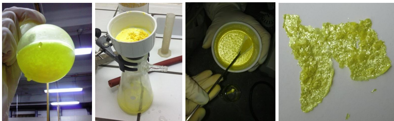
Figura 17 – Isolamento do produto por filtração a vácuo.
