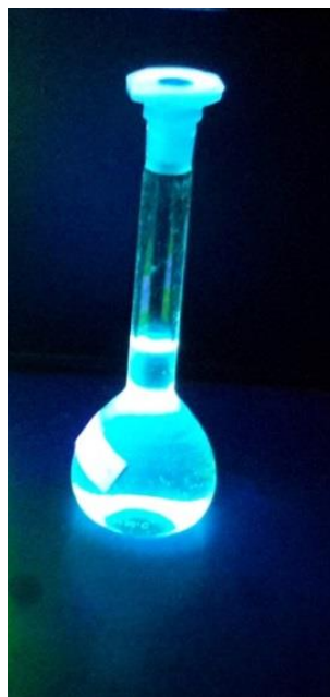
Figura 14 – Fluorescência do trans -9-(2-feniletinil)antraceno dissolvido em etanol sob a lâmpada de UV.
