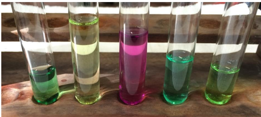
Fig. 15 - Adição do ligando oxalato após a sucessiva adição, aos aquocomplexos de \text{Cr(III)} , \text{Fe(III)} , \text{Co(II)} , \text{Ni(II)} e \text{Cu(II)} , de \text{NCS}^-
