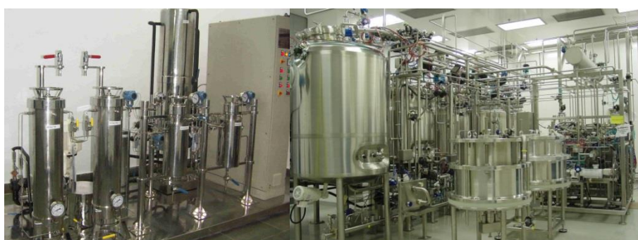
Figura 10 – Tecnologias aplicadas no downstream processing: a) extracção supercrítica e b) extracção com solventes.
