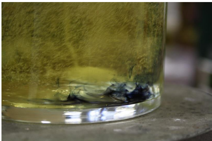
Fig. 18 - início da formação do complexo amido e o ião triiodeto - cor azul
