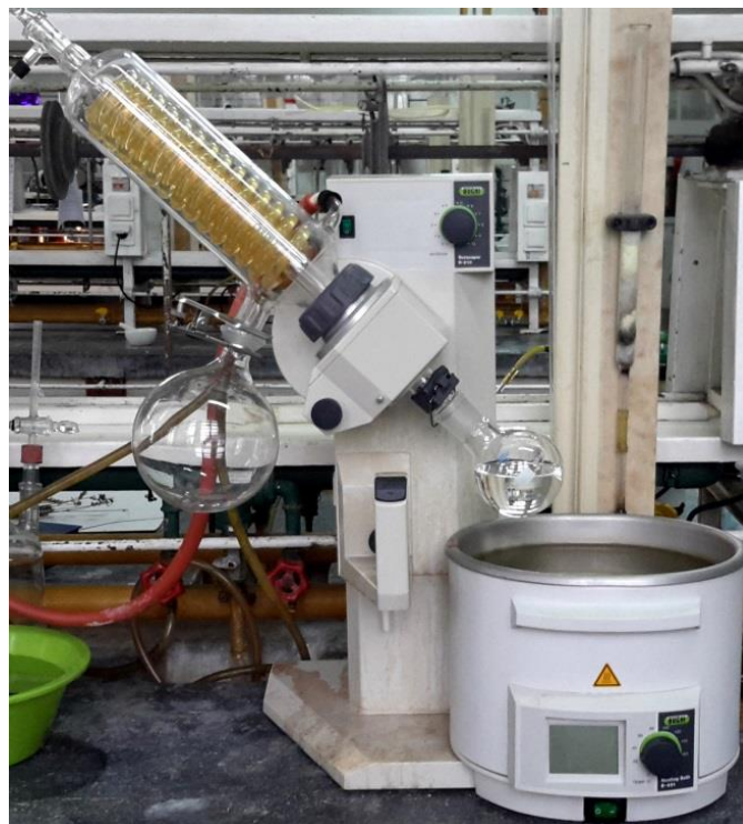
Figura 7 – Destilação do diclorometano num rotavapor
