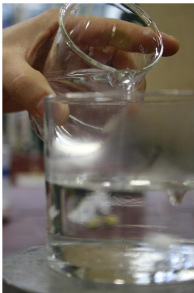
Fig. 16 - Adição da solução de peróxido de hidrogénio às de iodato de potássio e de permanganato de manganês II
