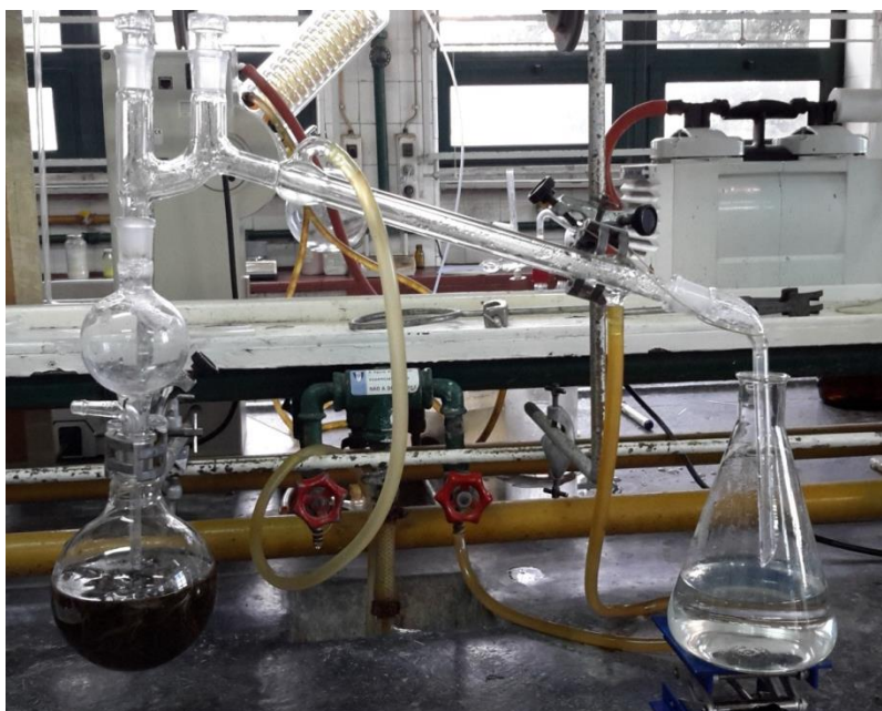
Figura 5 - Destilação por arrastamento de vapor das folhas de alecrim.
