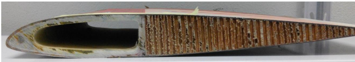
Figura 8. Secção transversal de uma pá da cauda de um helicóptero constituída por compósito de resina epóxi reforçada com fibra de vidro, estrutura em sandwich tipo ninho de abelha e alumínio.
