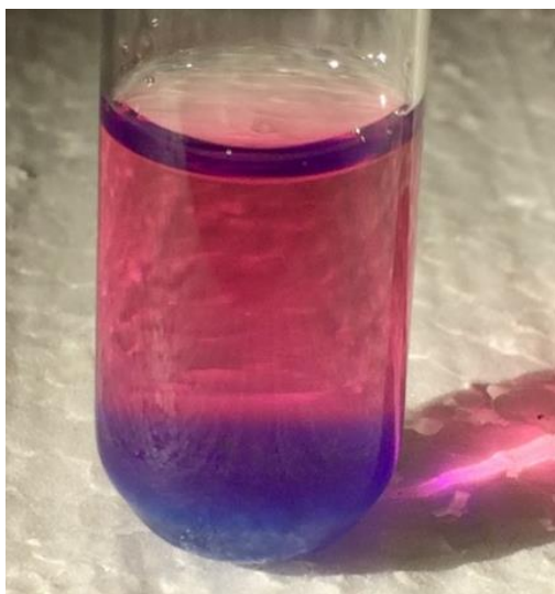
Fig. 12 - A solução cor de rosa corresponde ao complexo de oxalato, formado por adição deste ligando à solução azul/arroxeadada do complexo com tiocianato.
