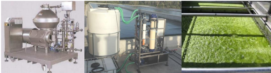
Figura 8 – Tecnologias utilizadas na concentração de microalgas: a) centrifugação, b) filtração por membranas e c) flotação por ar dissolvido.
