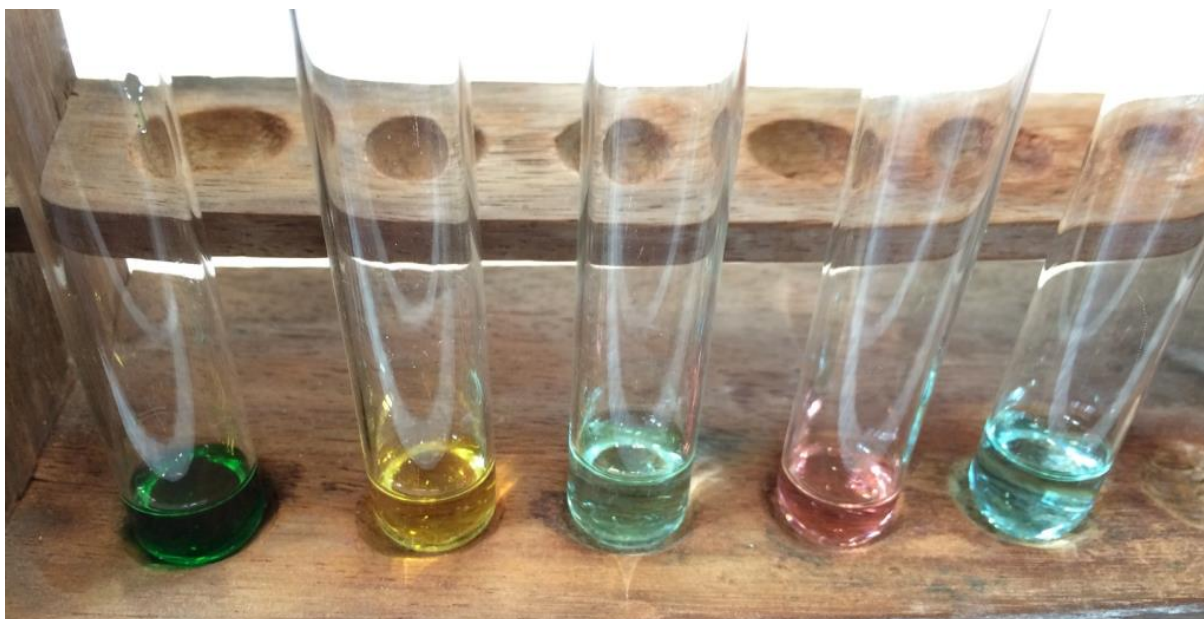
Fig. 4 - Soluções aquosas de Cr(III) , Fe(III) , Ni(II) , Co(II) e Cu(II) , que correspondem aos respectivos aquocomplexos
