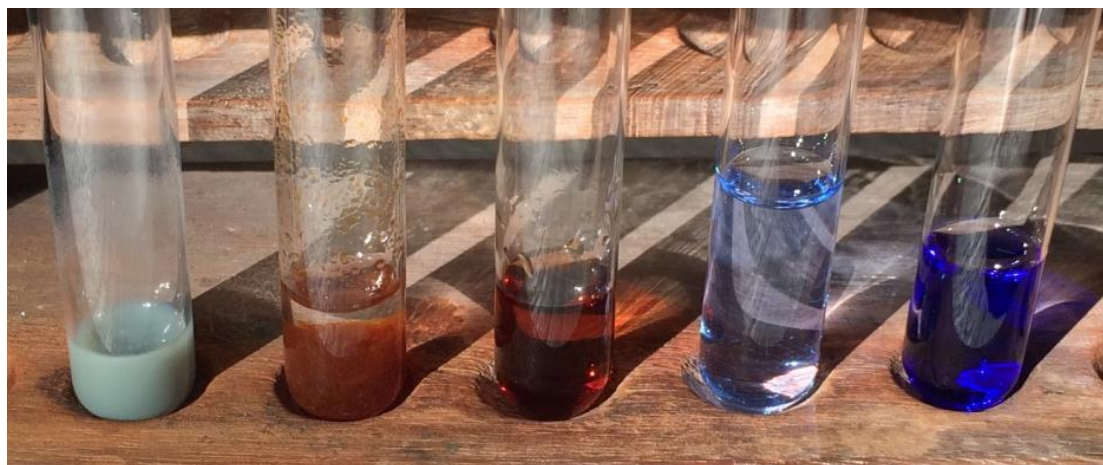
Fig. 8 - Adição de NH_3 aos aquocomplexos de Cr(III) , Fe(III) , Co(II) , Ni(II) e Cu(II) .
