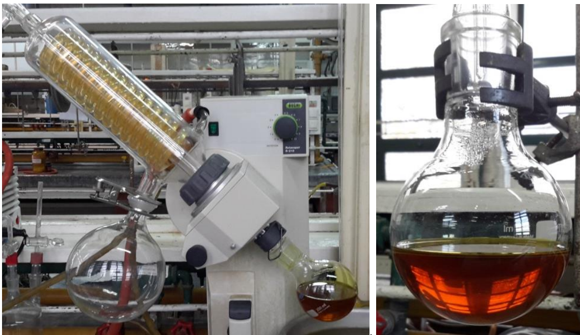
Figura 12 - Destilação do etanol num rotavapor
