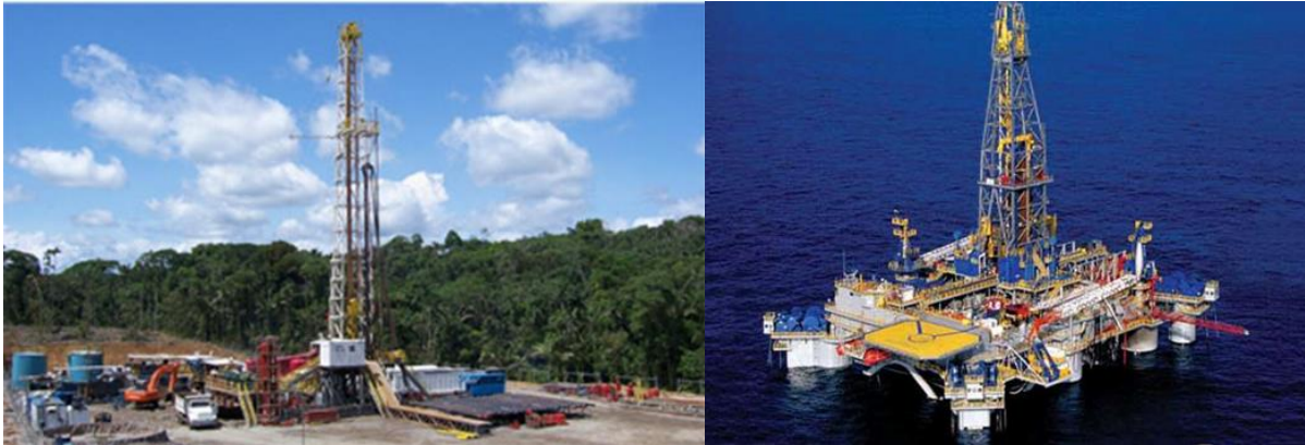
Figura 6 – Plataforma de perfuração terrestre (à esquerda) e marítima (à direita). [5]
