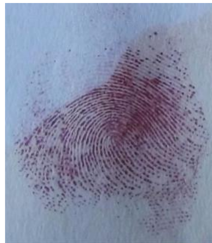
Fig. 3 – Método da ninidrina: esquema reaccional da reacção da ninidrina com um aminoácido [2] e revelação de uma impressão digital.
