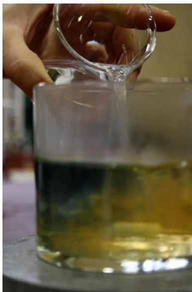
Fig. 19 - início da formação do complexo amido e o ião triiodeto - cor azul
