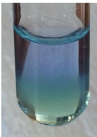
Fig. 13 - Aquocomplexo de níquel - verde - após adição de EDTA com a consequente formação de [\text{Ni}(\text{EDTA})]^{2-}
