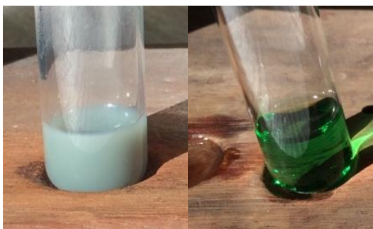
Fig. 5 - Precipitado cinzento de Cr(OH)_3 e solução verde escura de [Cr(OH)_4]^-
