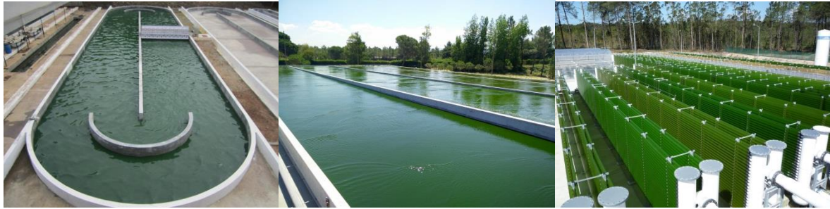
Figura 7 – Reactores de produção de microalgas: a) Raceway convencional, b) Raceway Cascata desenvolvido pela A4F e c) Fotobioreactores tubulares instalados pela A4F numa das maiores unidades de produção de microalgas do mundo.
