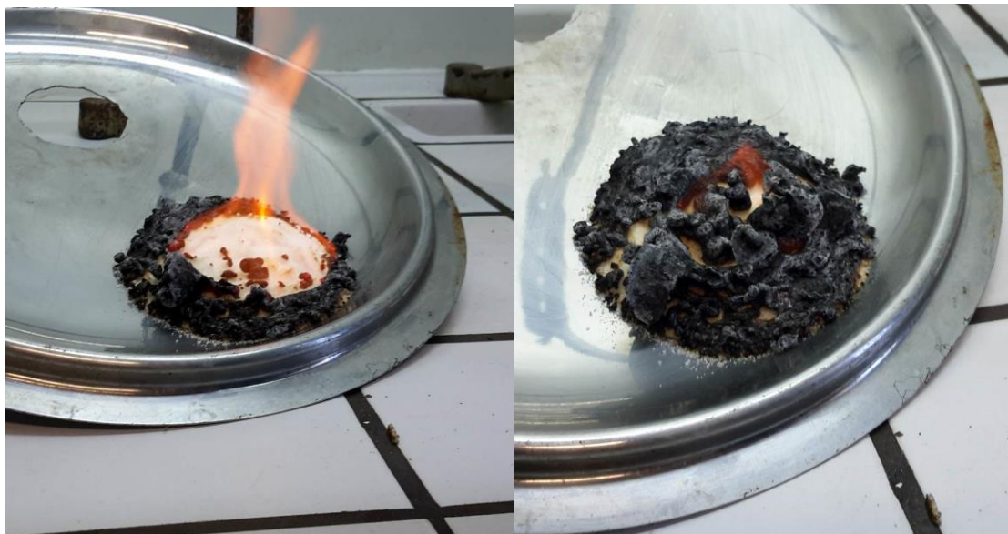
Figura 7 – Reação de combustão a ocorrer à medida que o “Black Snake” se forma.
