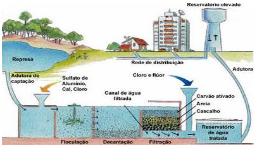
Figura 6 - Estação de tratamento de água 1 .
