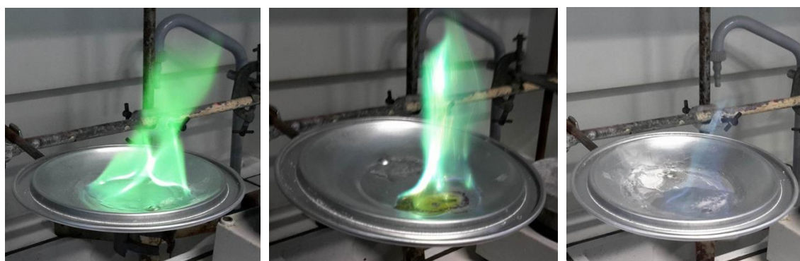
Figura 6 – Fogo colorido usando (da esquerda para a direita): ácido bórico, Cloreto de Cobre e Cloreto de Potássio.
