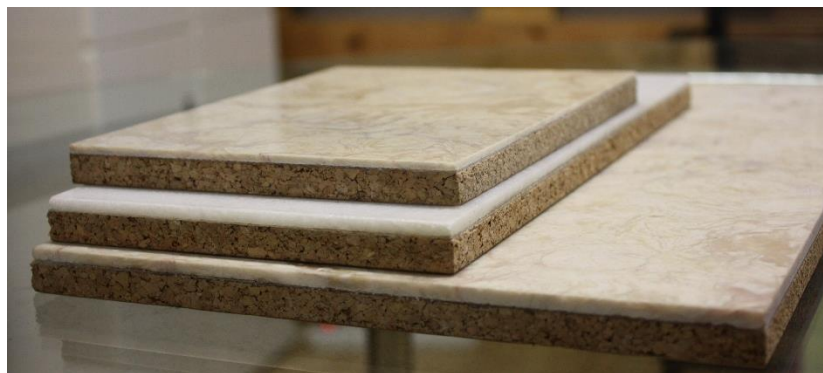
Figura 5 - Dois exemplos de materiais compósitos: materiais compósitos de matriz polimérica para pisos e materiais compósitos laminares para revestimentos e pavimentos.
