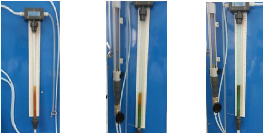
Figura 2 – Coluna da esquerda sem solução de sulfato de cobre, coluna do meio com solução de cobre e a coluna da direita exausta em sulfato de cobre
