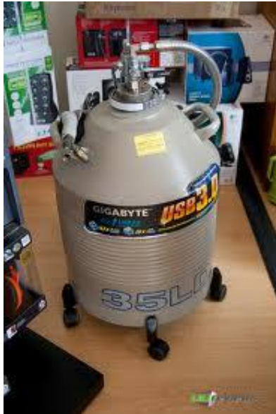
Fig. 5 - Dewar para transporte e armazenamento de azoto líquido
