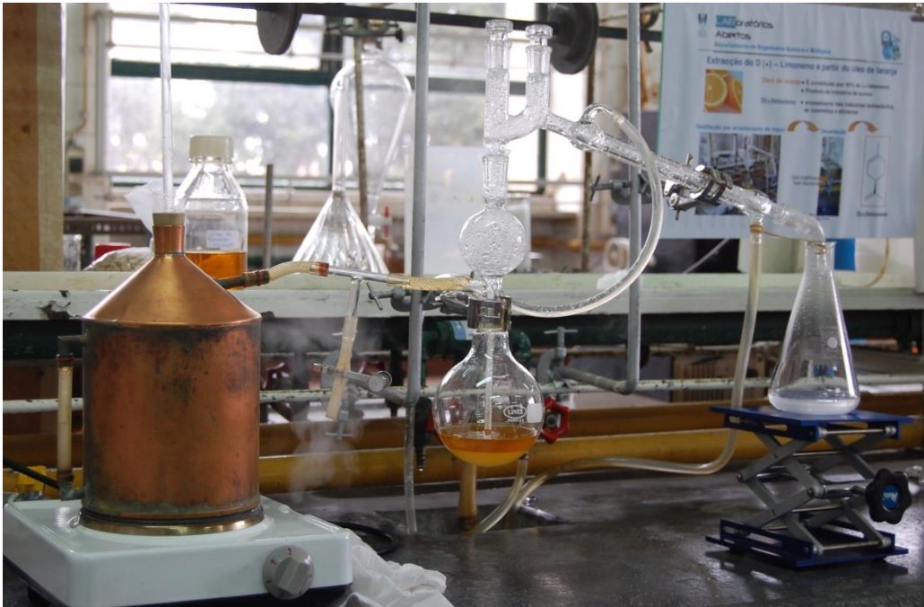
Figura 4 - Destilação por arrastamento de vapor do óleo de laranja.
