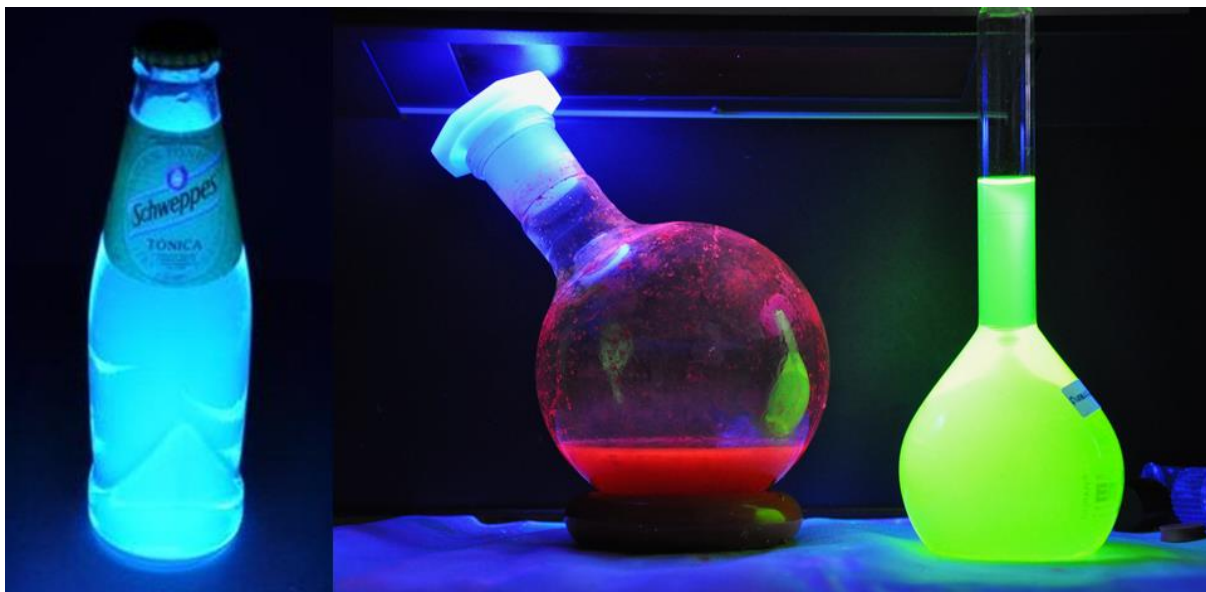
Figura 21 – Água tónica, solução de eosina e de fluoresceína sob luz ultra violeta.
