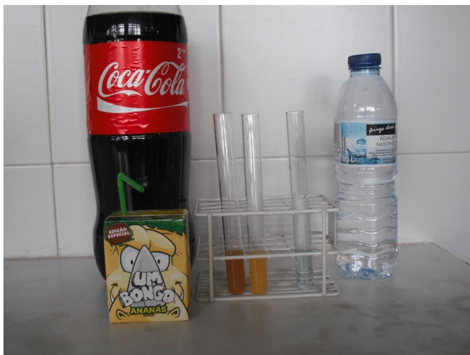
Figura 5 - Teste de Benedict para duas amostras (Coca-Cola, Bongo) e um branco (água mineral).
