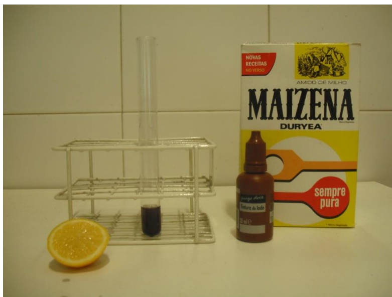
Figura 11 - Identificação de vitamina C numa amostra de sumo de limão.
