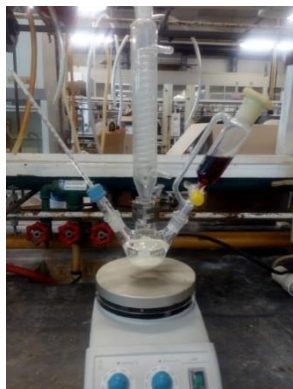
Figura 13 – Montagem para a reacção de síntese da vanilina.
