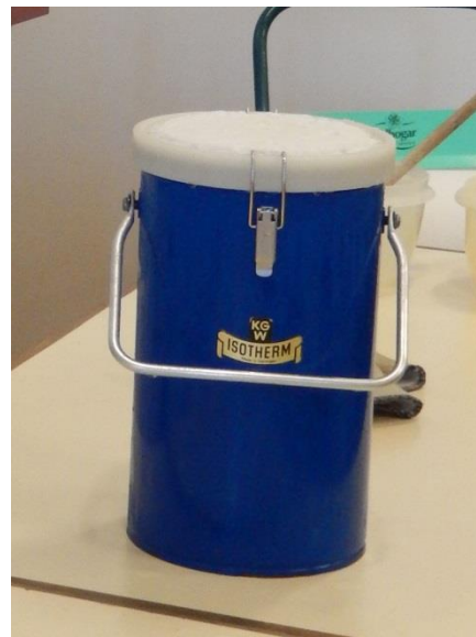
Fig. 5 - Dewar para transporte e armazenamento de azoto líquido
