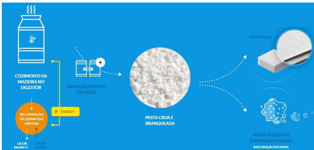
Figura 3 – Diagrama da Produção de Pasta. Adaptado de (1).
