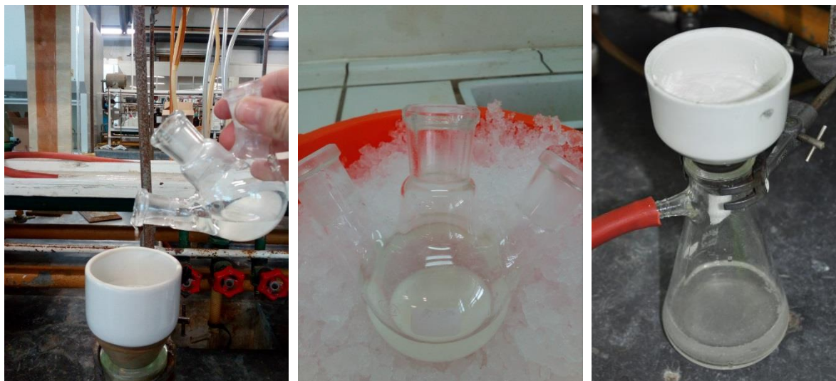
Figura 14 – Isolamento do produto por filtração a vácuo.
