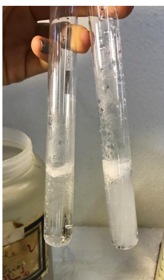
Figura 14 – Libertação de H_2 gasoso mais violenta, devido à reação entre HCl e Mg em pó (à direita) e reação com magnésio em fita, muito menos violenta (à esquerda).
