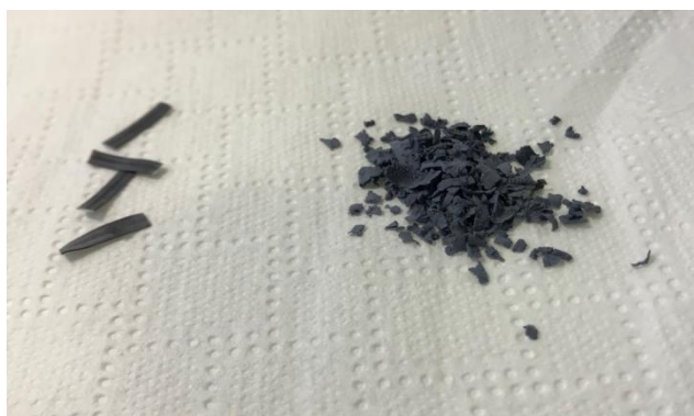
Figura 13– Magnésio em fita (à esquerda) e magnésio em pó (à direita).
