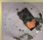
Foto Ag 48, resíduo da reacção do nitrato de prata com placa de cobre. As suas micropaisagens revelam aspectos inusitados desta reacção, mostrando que ela não é assim tão simples. Fotomicrografias Ag 49, 50, 51, 126x, em baixo.
