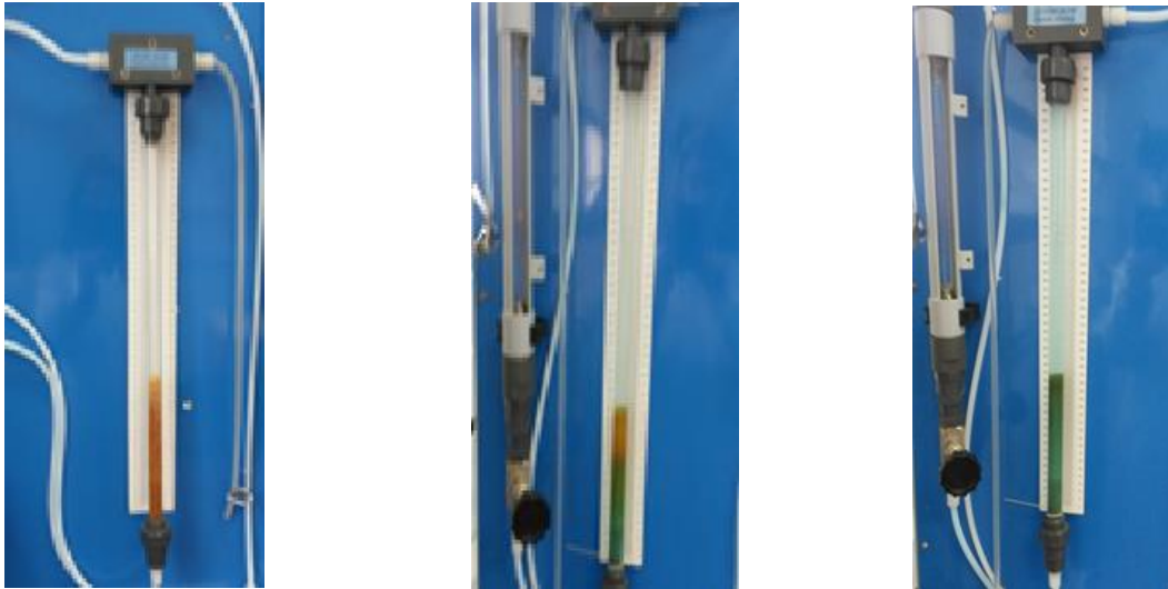
Figura 5 – Coluna da esquerda sem solução de sulfato de cobre, coluna do meio com solução de cobre e a coluna da direita exausta em sulfato de cobre
