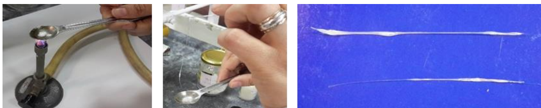
Figura 4 – Formação de fibra de poliestireno
