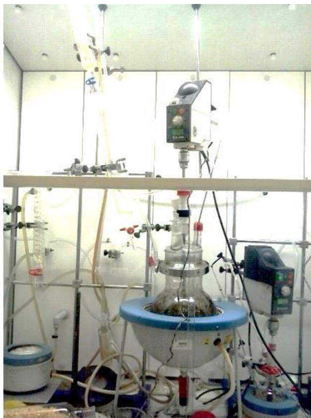
Figura 2 – Fotografia da montagem laboratorial utilizada na reacção de liquefacção de biomassa e esquema ilustrativo com indicação do material de laboratório utilizado.
