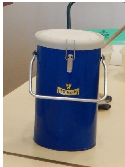
Fig. 2 - Dewar para transporte e armazenamento de azoto líquido
