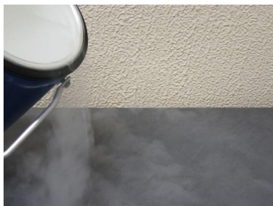
Figura 1 – Reservatório para conservar o nitrogénio líquido; caso este entre em contacto com uma superfície a temperatura superior, passa rapidamente ao estado gasoso.
