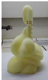
Figura 4 – Decomposição da água oxigenada com iodeto de potássio
