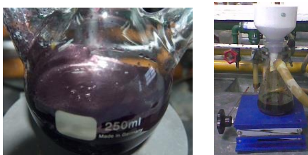
Figura 3 – Precipitação do indigo e filtração em vácuo
