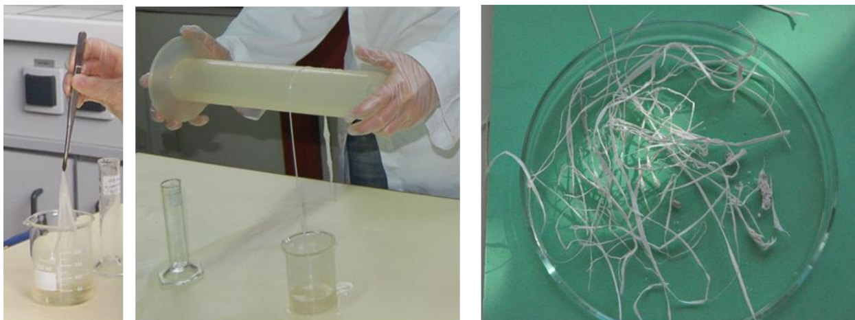
Figura 7 – Formação do fio de nylon
