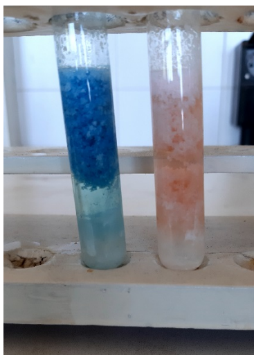
Figura 7. Testes de identificação de ferro numa amostra de leite enriquecido por adição de hexacianoferrato(II) de potássio (esquerda) ou de tiocianato (direita).
