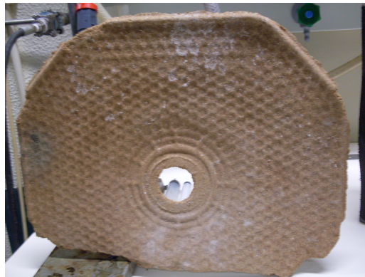
Figura 7. Bolo de filtração de dreche com 15% de humidade obtido no filtro prensa com possibilidade de desidratação térmica assistida por vácuo.
