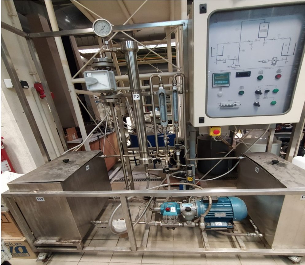
Figura 8. Unidade piloto de produção de água desionizada por osmose inversa.
