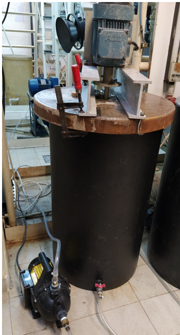
Figura 9. Tanque misturador de produção de solução alccolica desinfectante a 70%.
