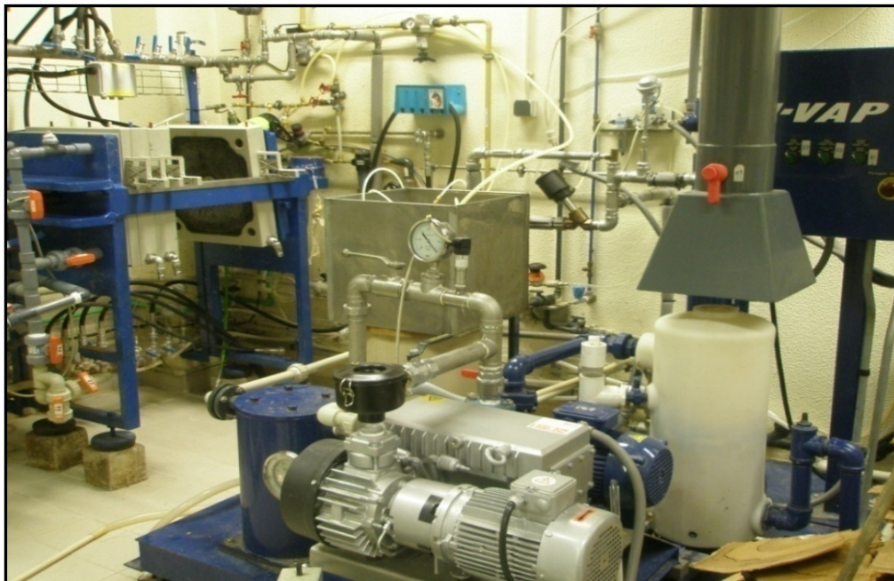
Figura 6. Filtro prensa piloto com placas de membrana e equipamento de desidratação térmica sob vácuo.
