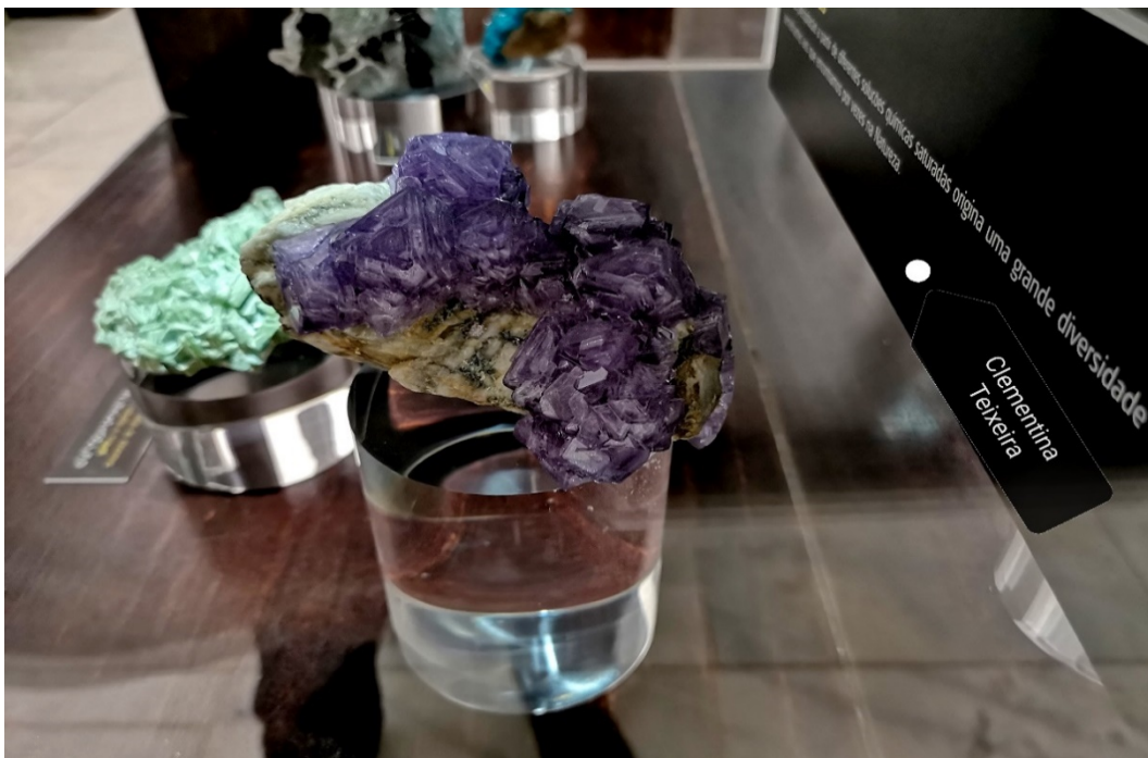
Figura 2. Cristais “On the Rocks” no Centro Ciência Viva de Estremoz (cristais artificiais), coleção oferecida em 2003. Em baixo, em destaque, cristais violeta imitando as ametistas. Trata-se de uma solução sólida de alúmenes de potássio (incolor) e de alúmen de cromo, isoestruturais (sistema cúbico).
