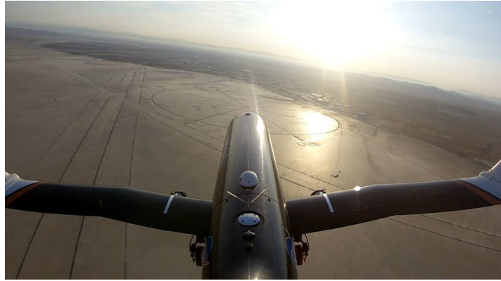
Figura 5. Nova liga desenvolvida pela NASA permite ajustar a forma das asas do avião durante o voo, otimizando a aerodinâmica e adaptando-a aos variados regimes de voo [4].
