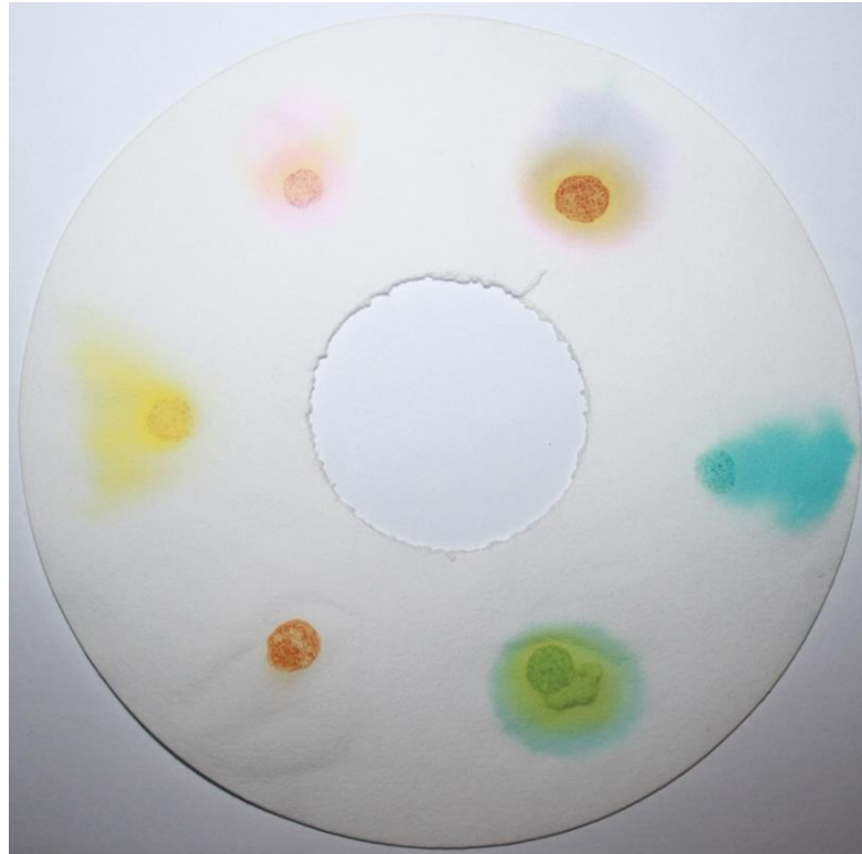
Figura 11: Resultado da cromatografia, com visível separação dos pigmentos.
