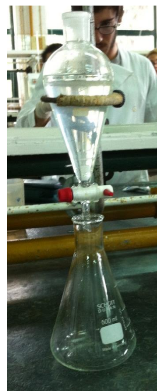
Figura 4 - Separação do limoneno (fase orgânica) da fase aquosa
