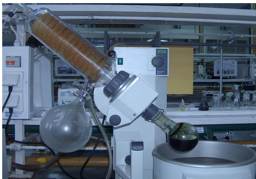
Figura 8 – Destilação do etanol num rotavapor
