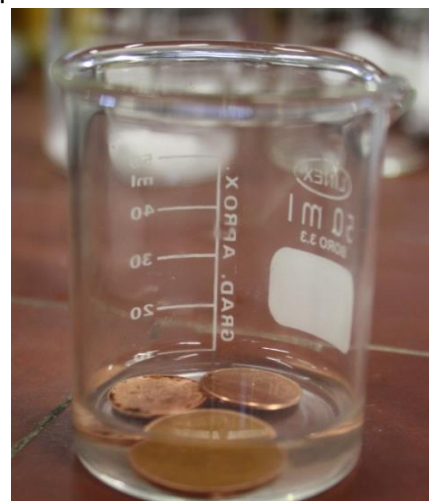
Figura 8: Limpeza das moedas em solução ácida
