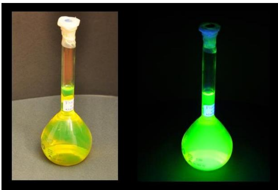
Figura 21 – Solução básica de fluoresceína sob luz natural e sob luz ultra violeta.
