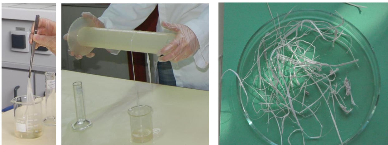
Figura 15 – Formação do fio de nylon
