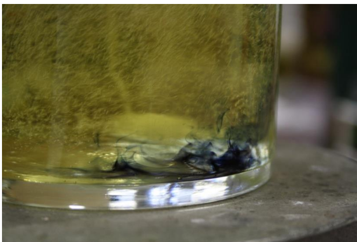
Figura 3: início da formação do complexo amido e o ião triiodeto - cor azul
