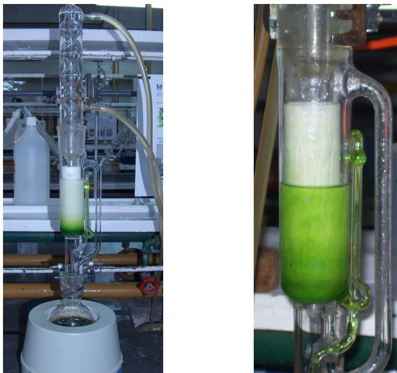
Figura 6 – Extração da clorofila em soxhlet
