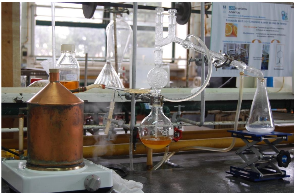
Figura 3 - Destilação por arrastamento de vapor
