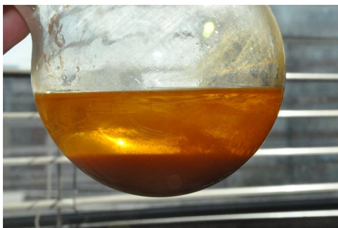
Figura 12 – Precipitação da fenil-hidrazona.
