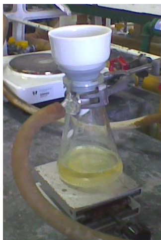
Figura 13 – Precipitação do produto e filtração em vácuo
