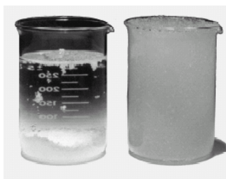
Figura 4 – Capacidade de absorção de um polímero superabsorvente.
