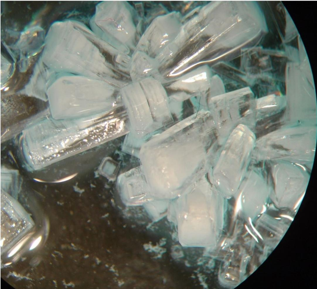
Figura 7 – Experiências com solução de limpeza de prata com tiourea em cristalizadores e placas de Petri antes de ser utilizada. Em baixo, cristais com oclusão de solvente e aspecto gelatinoso vistos à lupa estereoscópica, 10x.
