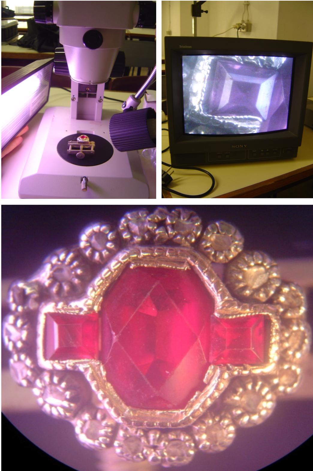
Figura 2 – Lupa estereoscópica binocular Nikon®, com câmara Sony®. Observação dum anel muito antigo de rubi, com aparas de diamante encastoadas em prata, 10x, limpeza do anel na Fig.1, e mais detalhes nas Figs.3,4,6.
