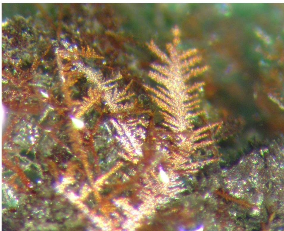
Figura 15 – Ao fim de algum tempo (vide, Figs.16,17), começam a precipitar cristais de compostos de cobre (2+) de cor entre o azul e o esverdeado sobre os fractais de prata formados (em cima). Na fotomicrografia de baixo, nas mesmas reações, começam a formar-se fractais de cobre metálico, “árvores”, devidas à dismutação de  $\text{Cu}^+$  em  $\text{Cu}^{2+}$  e  $\text{Cu}$ . Lupa estereoscópica, 126x [6,29].
