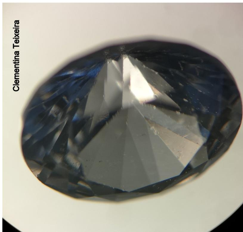
Figura 14 – Zircónia cúbica sintética à lupa estereoscópica, 20x.
